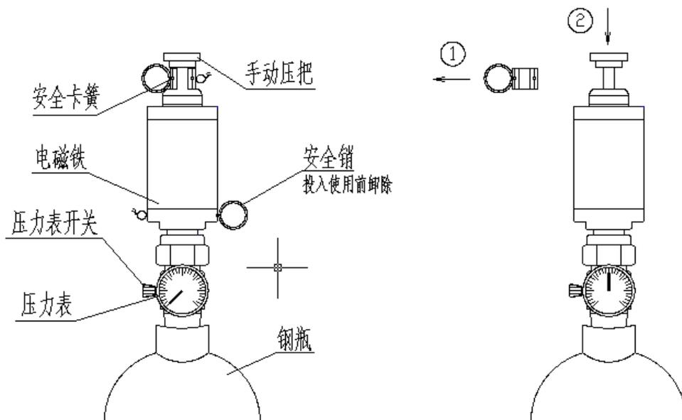
② 驱动气体瓶组的驱动阀或电磁阀失效时，逐一打开灭火剂瓶组上的容器阀(拉出手动保险销、套上手柄向下拉到下止位置)。
